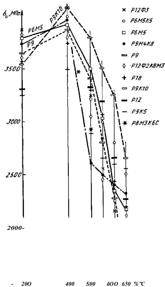
Рис. 2.22. Зависимость прочности быстрорежущих сталей от температуры
