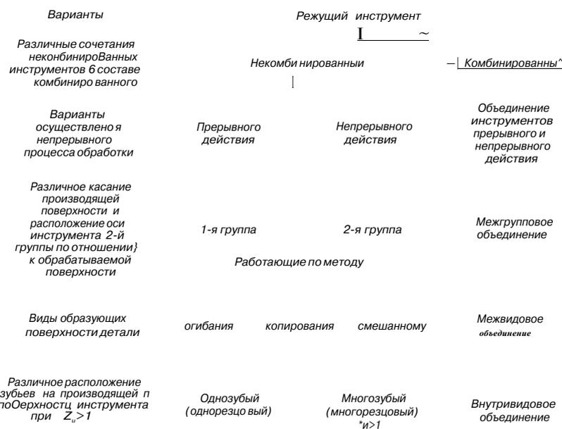
Рис. 2.11а Классификация видов режущего инструмента
