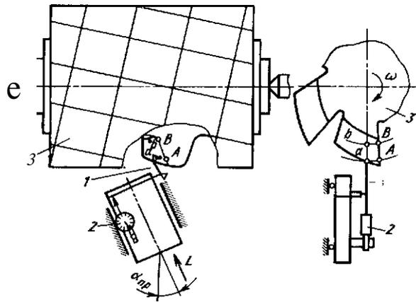
Рис. 4.4. Схема контроля профиля по кромке в осевой плоскости
