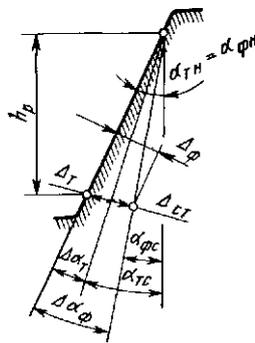
Рис. 3.18. Погрешность профиля фрезы при стачивании
