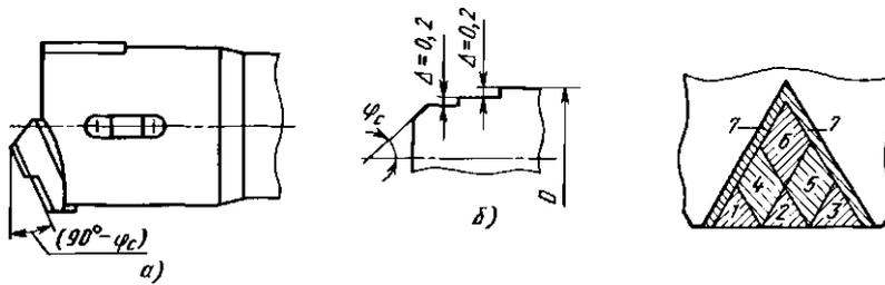
Рис. 2.19. Инструменты со ступенчатой главной режущей кромкой:
