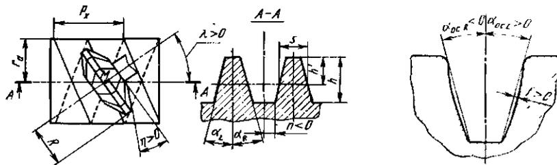
Рис. 2.47. Основные размеры червяка и фрезы Рис. 2.48. Получающийся профиль червяка в его осевом сечении
