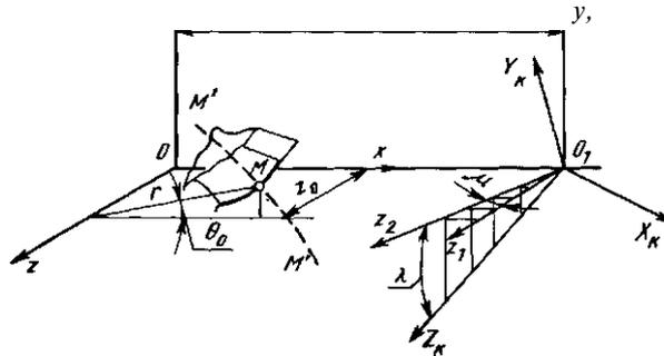
Рис. 2.42. Системы координат при расчете профиля
