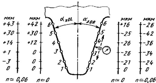
Рис. 3.19. Результаты измерений профиля новой (\$l = 0\$) и сточенной (\$n = 0,06\$) фрезы
