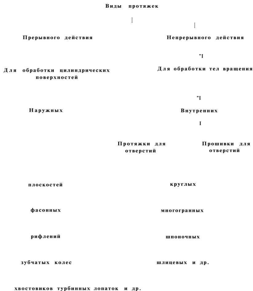
**Рис. 3.8. Классификация видов протяжного инструмента**
