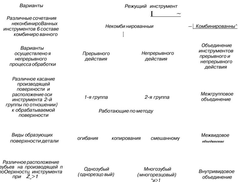
Рис. 2.11<sub>а</sub> Классификация видов режущего инструмента
