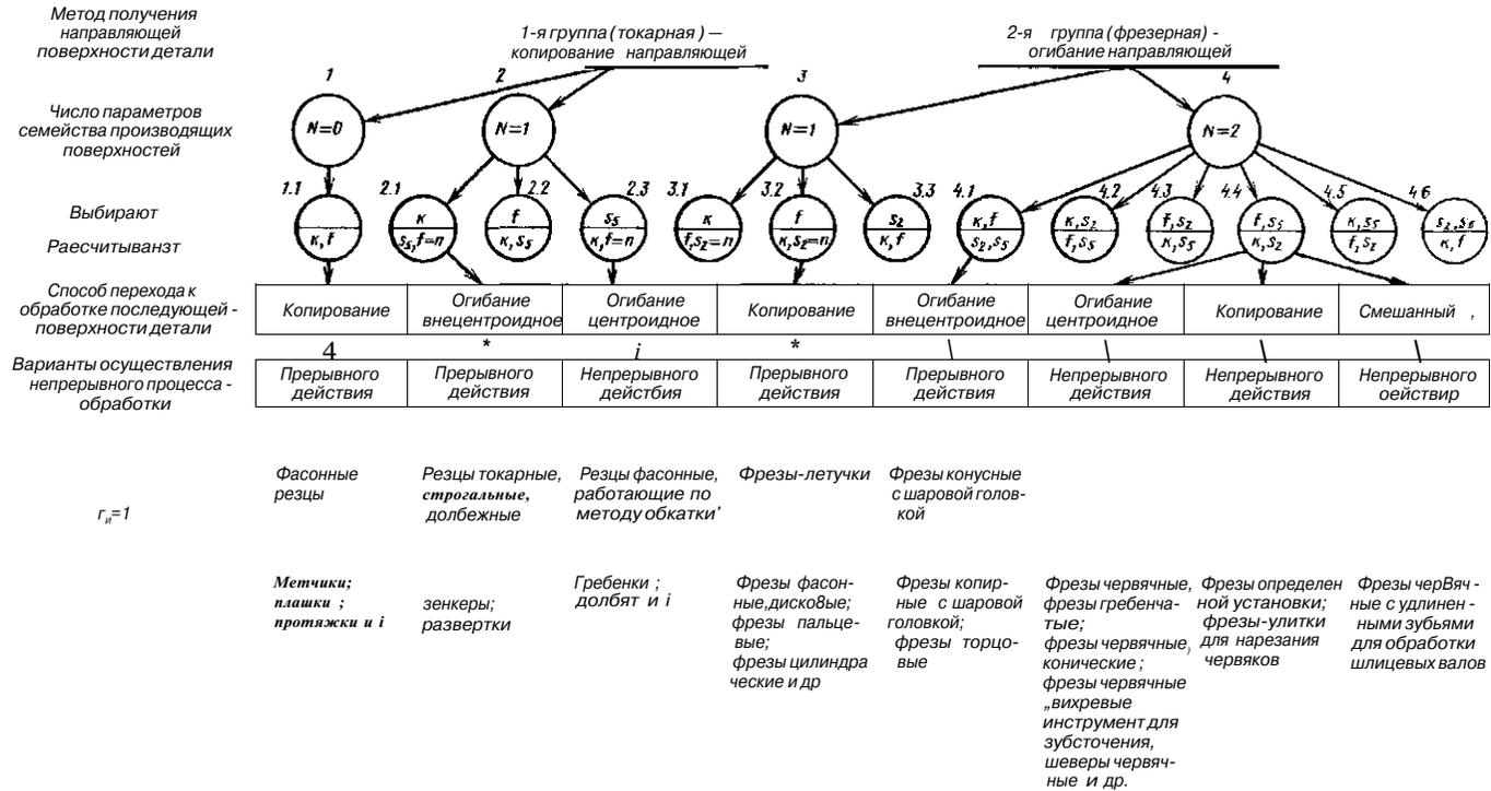
Рис. 2.10. Множество некомбинированных видов режущего инструмента
