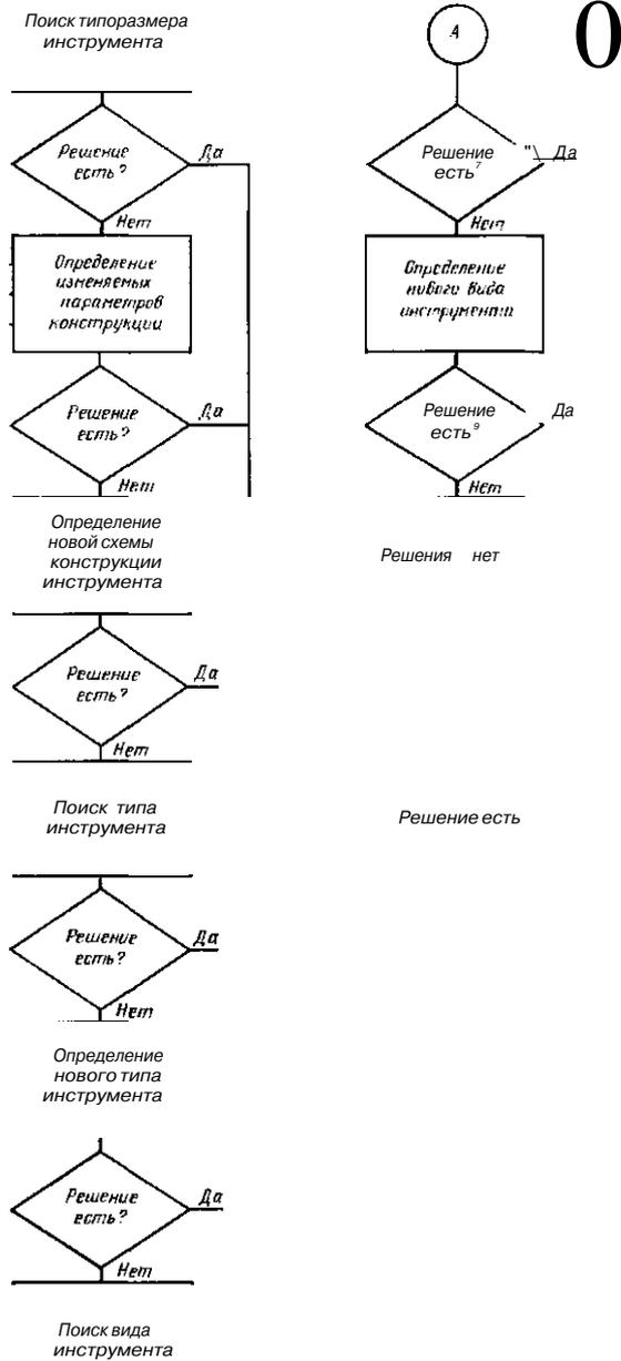
Рис. 2.2. Различные уровни решения задач проектирования режущего инструмента
