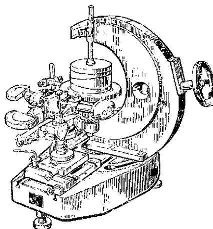
Рис. 90. Прибор фирмы «Цейсе» для измерения погрешности окружного шага
