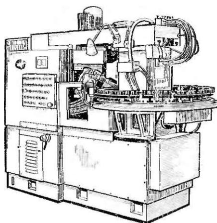
Рис. 104. Зубофрезерный автомат с транспортером кольцевого типа
