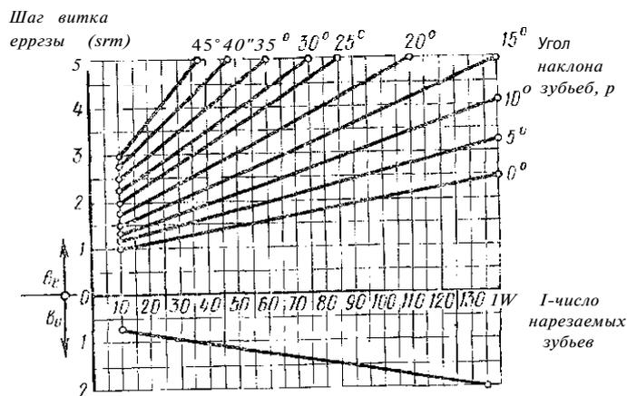
Рис. 25. График распределения рабочей длины червячной зуборезной фрезы
