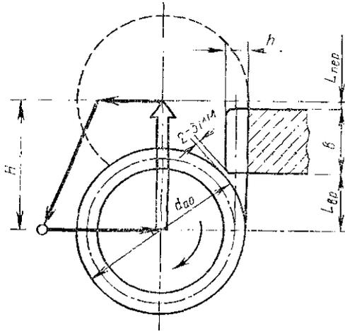
Рис. 26. Схема однопроходного цикла нарезания зубьев червячной фрезой
