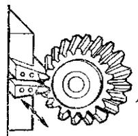
Строгание зубьев по копиру одним или двумя резцами на зубострогальном станке
