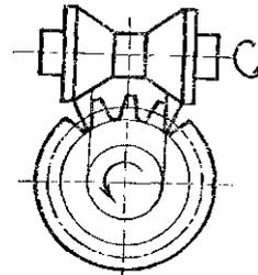
Нарезание витков цилиндрического червяка дисковой фрезой на червячно-фрезерном станке
