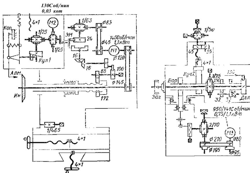
Рис. 66. Кинематическая схема зубшлифовального полуавтомата 5A893С
