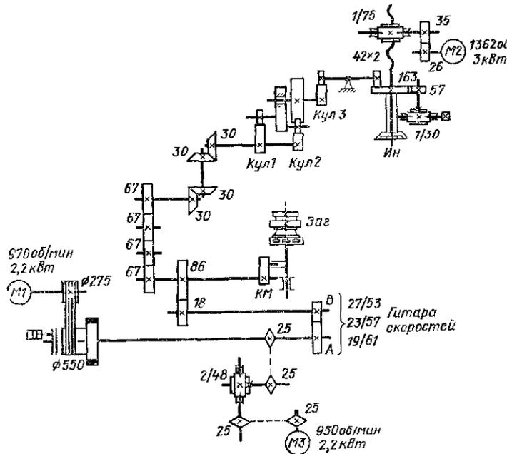
Рис. 51. Кинематическая схема зубодолбежного полуавтомата 5130
