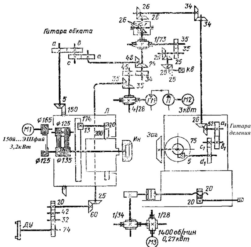
Рис. 88. Кинематическая схема зубошлифовального полуавтомата 5A870B
