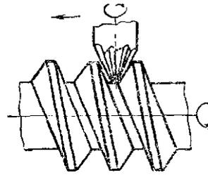
Нарезание витков цилиндрического червяка профильным резцом на токарно-винторезном станке
