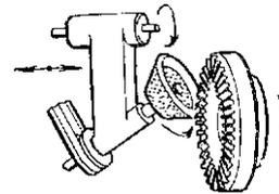
Притирка зубьев на зубопритирочном станке
