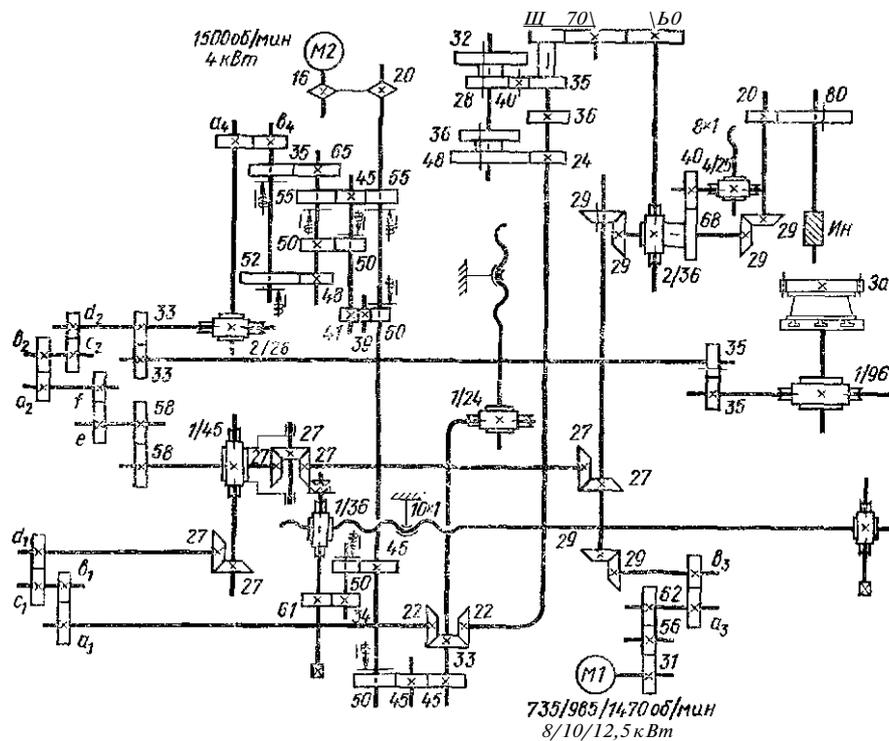
Рис. 30. Кинематическая схема зубофрезерного полуавтомата 53A50
