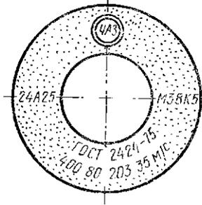
Рис. 58. Пример маркировки абразивного круга
