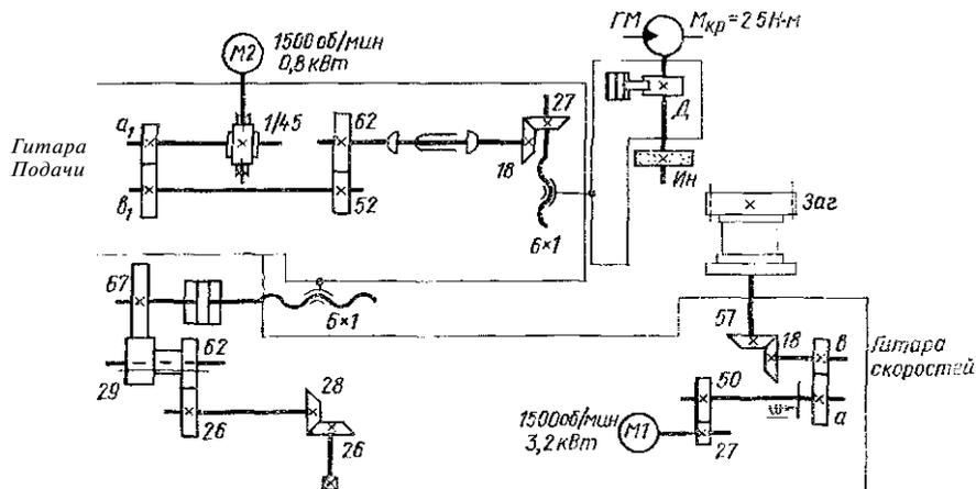
Рис. 57. Кинематическая схема зубохонинговального полуавтомата 5A915
