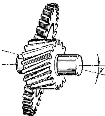
Рис. 55. Образование угла скрещивания осей шевера и изделия
