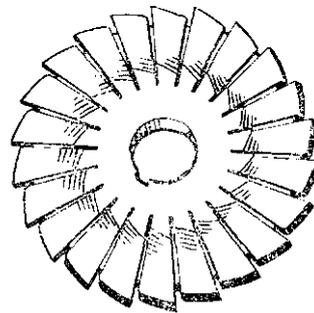
Рис. 39. Дисковая фреза для нарезания цилиндрического червяка
