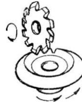
Фрезерование зубьев торцевой резцовой головкой на зуборезном станке по методу обката
